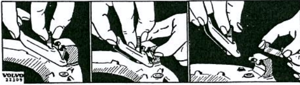
Bild 12. Demontering av hävarmar.
